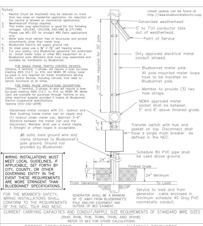
COPPER CONDUCTOR ALUMINUM CONDUCTOR Conduit/Nipple Size Wire Size Breaker Size Conduit/Nipple Size Wire Size Breaker Size 1¼" Conduit 1¼" Conduit 1½" Conduit 2" Conduit 1¼" Conduit 60 Amp #4 #6 60 Amp 1¼" Conduit #2 #4 100 Amp 100 Amp #2 125 Amp 125 Amp 1½" Conduit #1/0 #2/0 150 Amp Conduit 150 Amp 2" Conduit #2/0 #4/0 200 Amp Conduit 200 Amp
